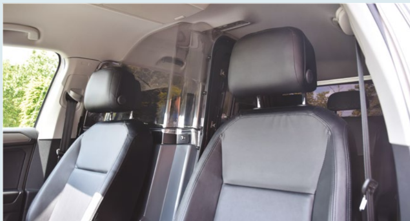
Cloison de séparation vue de face
